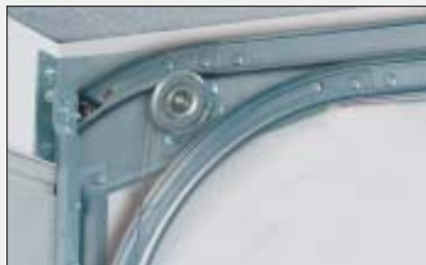
Направляющие для низкого подъема с выносом торсионных пружин назад, необходимый размер перемычки 250 мм.
