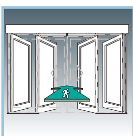
MI 6030/6130 Разблокировочная система для 2 подвижных и 2 фиксированных створок (шириной 1100/1500 мм каждая)
