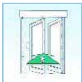
MI 6030/6130 Разблокировочная система для 1 подвижной и 1 фиксированной створки (шириной 1100/1500 мм каждая)
